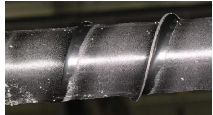
Zniszczenie przez nieuplastyczniony granulat
