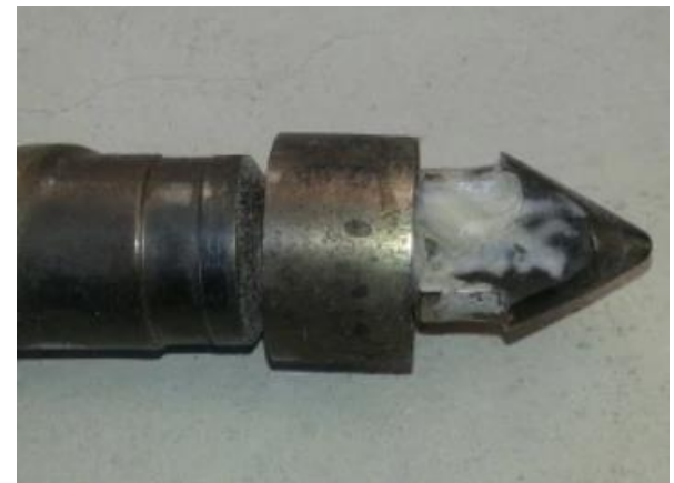
Zużyta końcówka ślimaka
