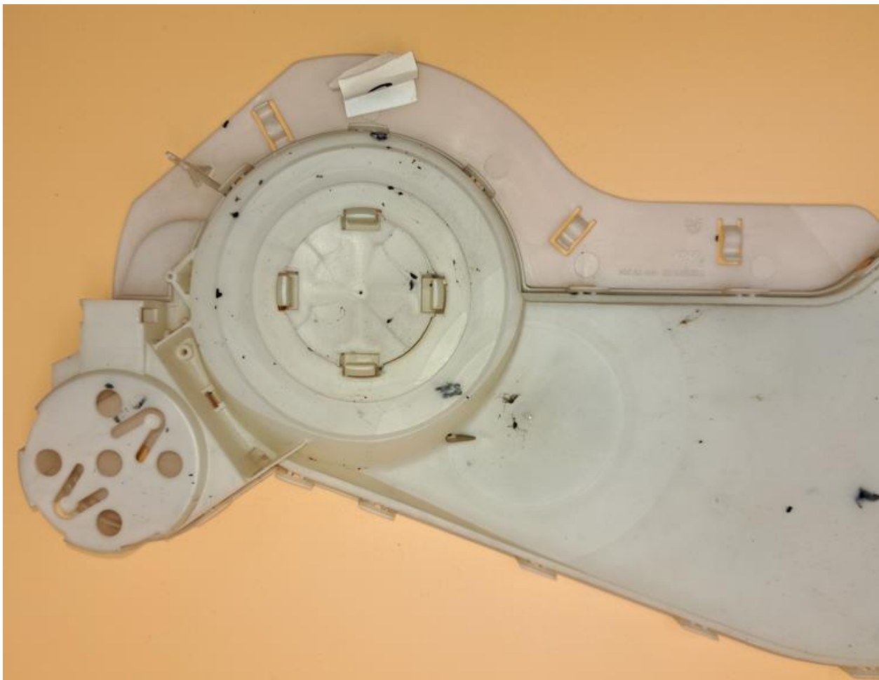
Odrywające się wtrącenia z układu uplastyczniania
